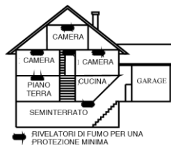
Figura 2: Posizionamento dei rivelatori di fumo e di calore in una abitazione su più livelli.
