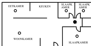
Figuur 1: Installatielocaties voor rook-/warmtedetectoren in ééngezinsappartementen of woningen met slechts één slaapruimte
